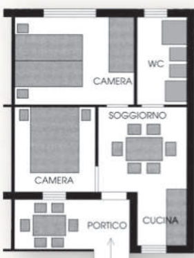
C trilocale in muratura
