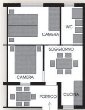
C trilocale in muratura
